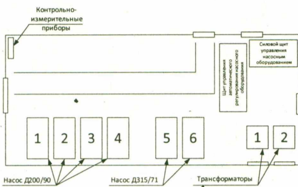
Рисунок 11. Схема расположения насосных агрегатов насосной станции II-го подъема города Мегион
