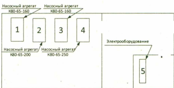
Рисунок 13. Схема расположения насосных агрегатов насосной станции II-го подъема водозабора №2 "Геолог".
