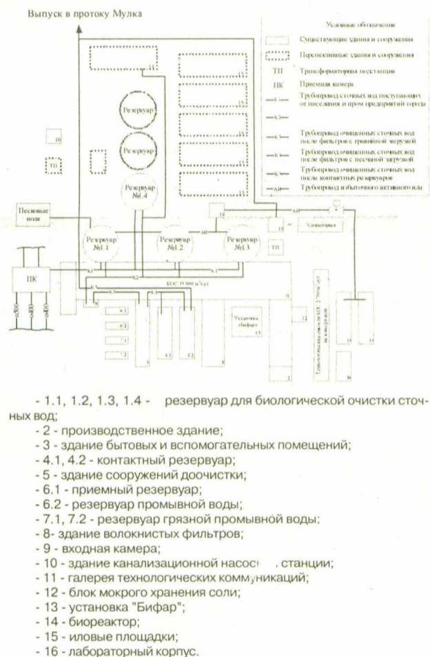
Рисунок 1. Технологическая схема КОС г. Мегиона
