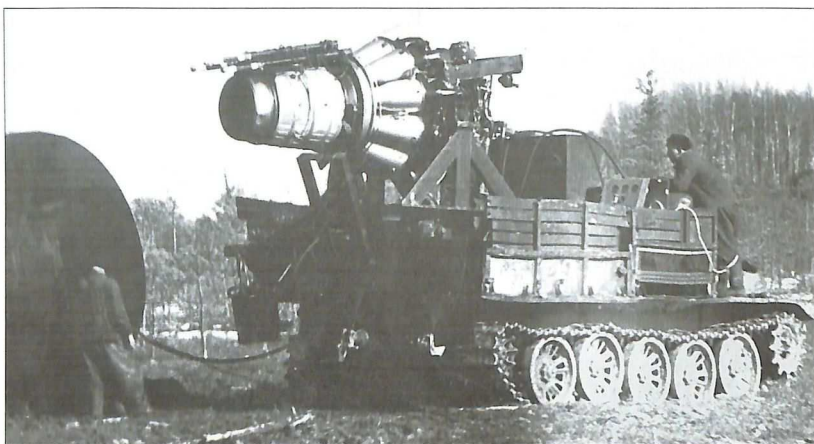
1972 г. Подготовка реактивной турбины (пушки) для укрощения нефтяного фонтана на Варьёгане.
