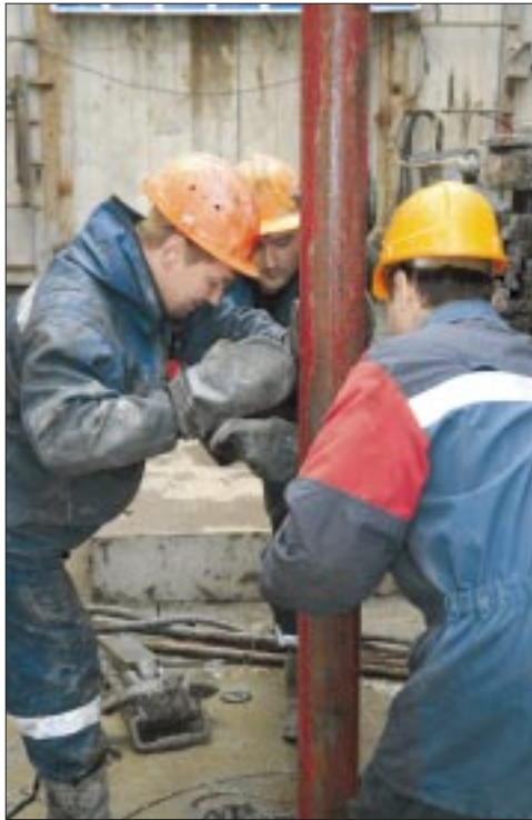
По команде «выброс» вахте необходимо оперативно, но без суеты и по всем правилам загерметизировать устье скважины. Бурильщик управляет спуском аварийной трубы, помощники контролируют, чтобы процесс проходил без помех
